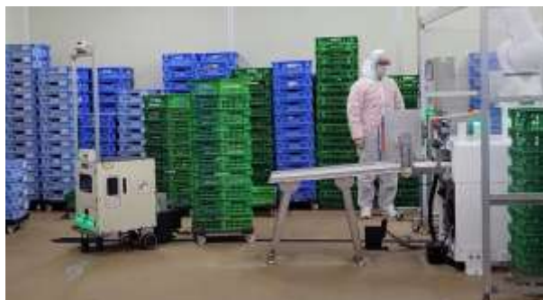
図5 出荷場へ台車搬送するAMR(自律走行搬送ロボット)
