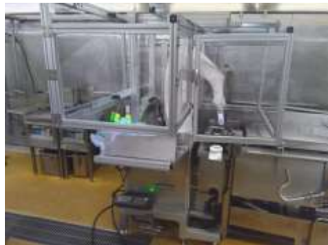
図4 弁当盛り付け(左)とフライ投入する(右)弁当盛付ロボットシステム
