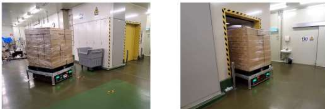
図9 冷凍惣菜をエレベーター経由で冷凍庫へ自律走行搬送するAMR
